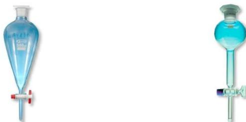
**Figure 2.** Les différents types d'ampoule à décanter.
